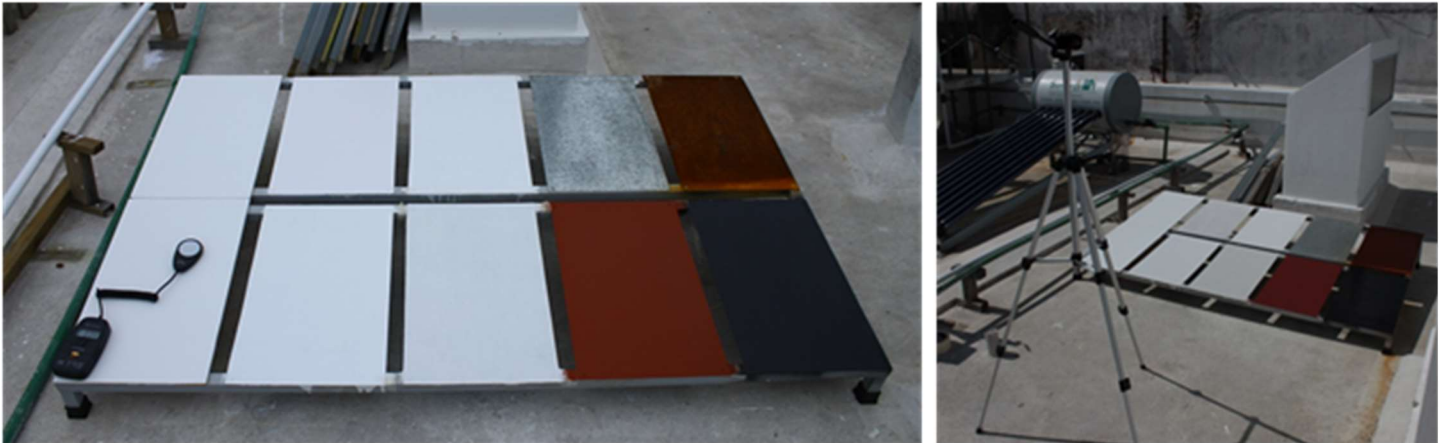
Figura 1: Disposición de la estructura con las muestras de acabados para láminas metálicas galvanizadas. Elaboración propia.
