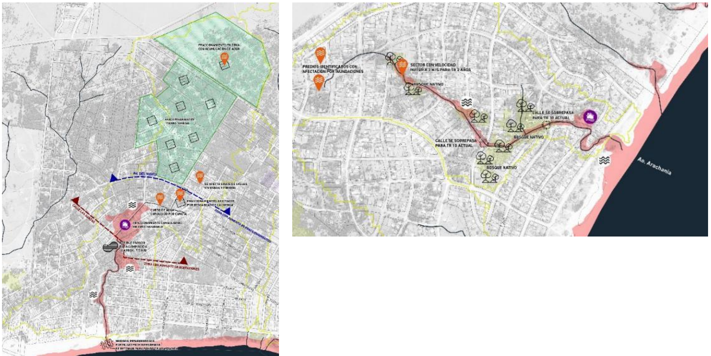
Figura 15. Esquemas de cuencas con descargas a playa. Identificación de áreas inundables, ecosistemas relevantes, fraccionamientos vacantes potencialmente urbanizables, problemas de drenaje pluvial identificados, propuestas de intervenciones y mejoras de infraestructuras entre otros aspectos (Fuente: Elaboración propia)
