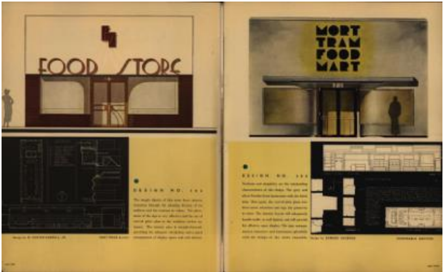
Figura 11. Diseños No. 502 y No. 568 presentados en el catálogo “52 designs to modernize Main street with glass” publicado por Libbey-Owens-Ford, Co. (LOF) en 1935. Estos diseños de escaparates con láminas de vidrio curvo, carpintería de aluminio y los muros con recubrimientos de Vitrolite coinciden en su expresión con la propuesta de González para el Copello.
